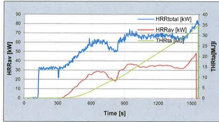
Şekil 13. Numune 5 için HRR_{av}(t) , HRR_{av-30s} ve THR değerlerinin grafiği
